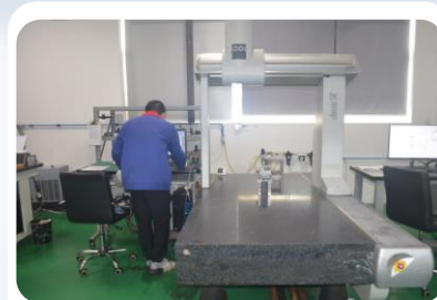
海克斯康高精度三坐 标检测仪 HEXAGON - CMM
